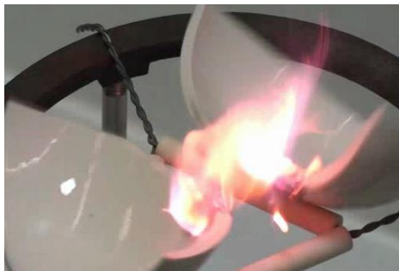
Abb. 5: Moment des Zerbrechens der Porzellanschale beim schlagartigen Erhitzen von Kalium
