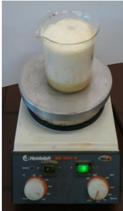
Abb. 2: Aufschäumen der Lösung.
