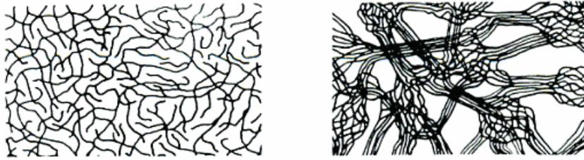
Abb. 8:<sup>[6]</sup> Geknäulte, amorphe Makromoleküle (links) und teilkristalline Makromoleküle (rechts) als Merkmal eines Thermoplasts.
