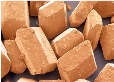
Abb. 3: Saccharose-Kristalle unter dem Elektronenmikroskop [2]
