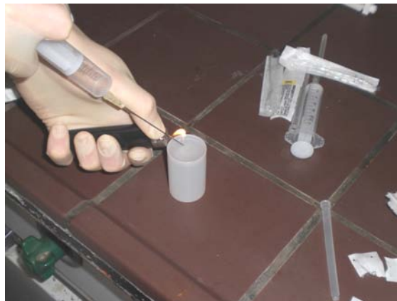
Abbildung 4: Test auf Brennbarkeit
