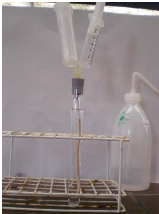
Abbildung 2: Aufbau einer provisorischen Gaswaschflasche
