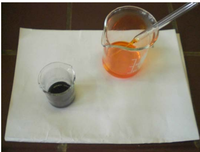
Abb. 3: Versetzung des Filtrates mit Kaliumdichromat-Lösung
