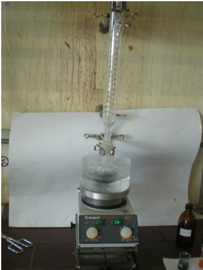
Abb. 1: Versuchsaufbau zum Erhitzen unter Rückfluss
