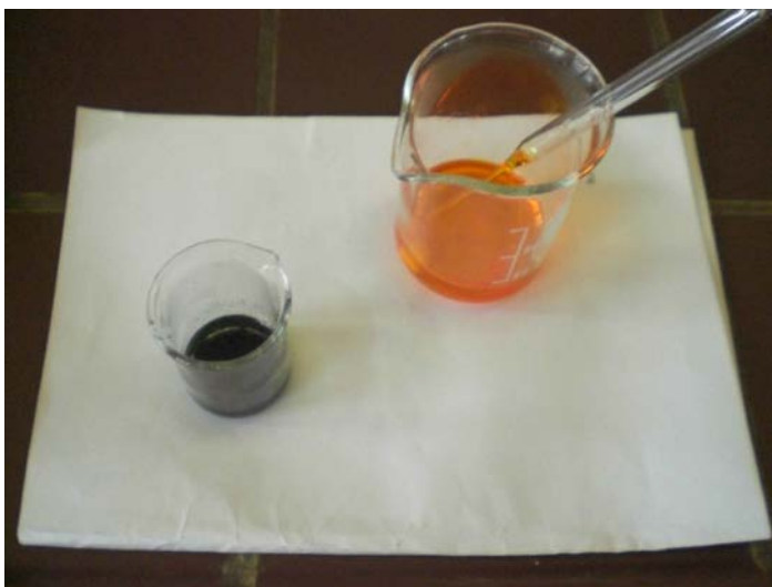
Abb. 3: Versetzung des Filtrates mit Kaliumdichromat-Lösung
