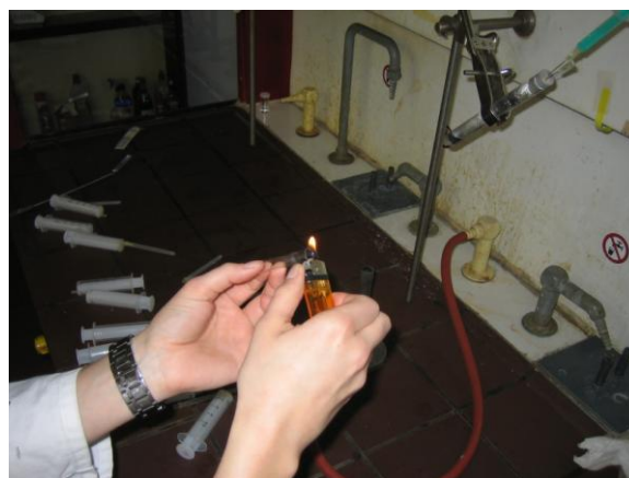
Abb. 4: Bestimmung der Dichte von Methan.
