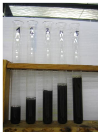
Abb. 2: Eisen(II)-sulfat-Lösung mit unterschiedlich viel Tee.
