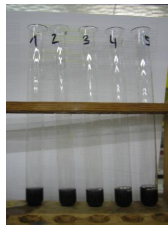
Abb. 3: Entnahme von 2 mL-Proben aus dem Eisen(II)-sulfat-Tee-Gemisch.
