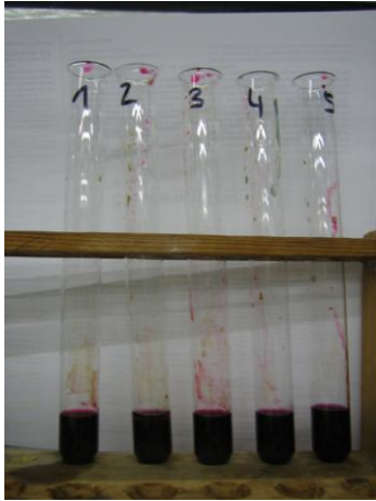
Abb. 4: Eisen(II)-sulfat-Tee-Gemisch- Proben mit ammoniakalischer Diacetyl- dioxim-Lösung.
