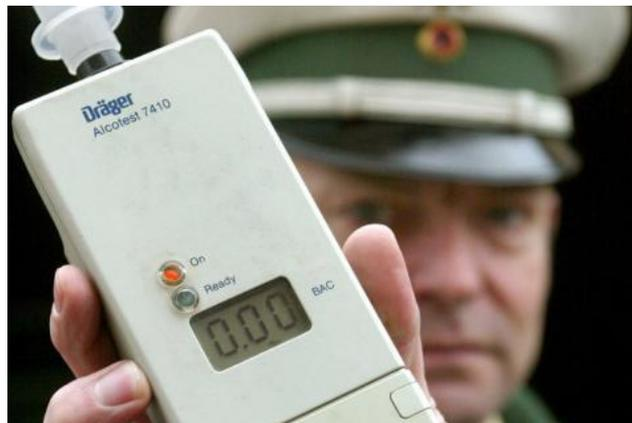
Abb. 4: Physikalisches Messgerät zur Überprüfung des Atemalkoholgehalts.
