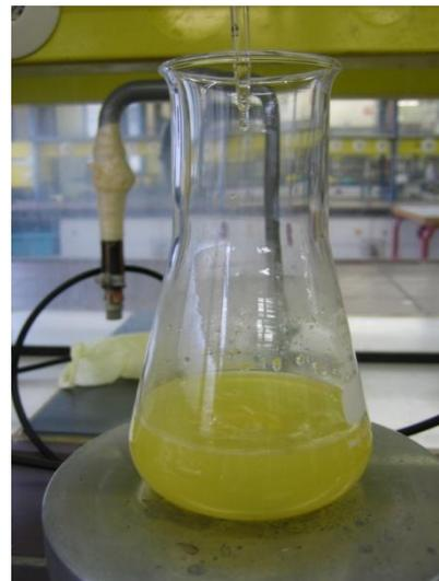
Abb. 3: Iodlösung während der Titration.
