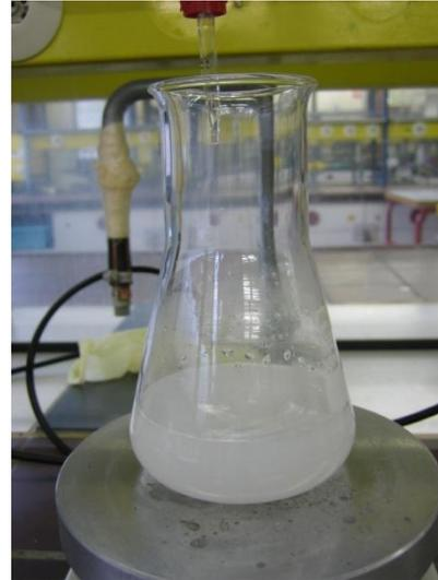
Abb. 5: Iodlösung bei abgeschlossener Titration.
