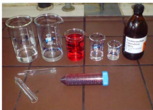
Abb. 1: Vorbereitetes Schweineblut sowie die Komponenten der Pufferlösung, die Phenolrot-Lösung, die Ethanol-Wasser-Lösung, die physiologische Kochsalzlösung, Trichlormethan und zwei Zentrifugengläschen.
