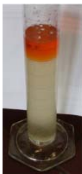
Abb. 4: Bromwasser + Cyclohexan nach dem Ausschütteln.
