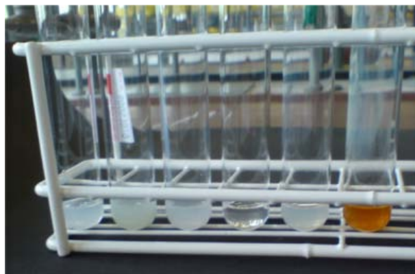
Abb. 2: Trübung nach Zugabe der ethanolischen Silbernitrat-Lösung
