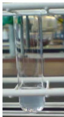
Abb. 3: Leichte Trübung nach der Zugabe weiterer ethanolischer Silbernitrat-Lösung.
