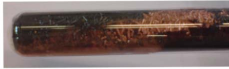
Abb. 2: Gebildetes elementares Kupfer zwischen dem Kupfer(II)-oxid
