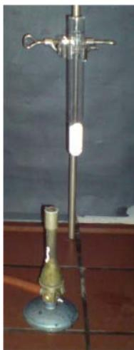
Abb. 1: Dickwandiges Reagenzglas mit dem Reaktionsgemisch und dem Gasbrenner.
