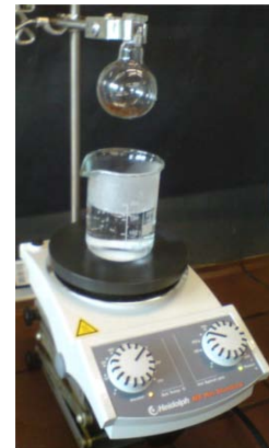
Abb. 2: Rundkolben mit Kaffeepulver und Wasserbad.
