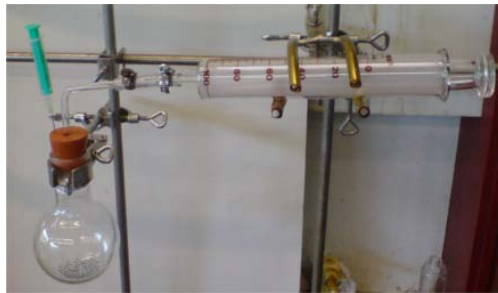
Abb. 1.: Apparatur zum Messen des Gasvolumens des eingesetzten Ethanols
