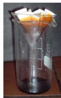
Abb. 2: Becherglas, Glastrichter und Faltenfilter mit Probenlösung.
