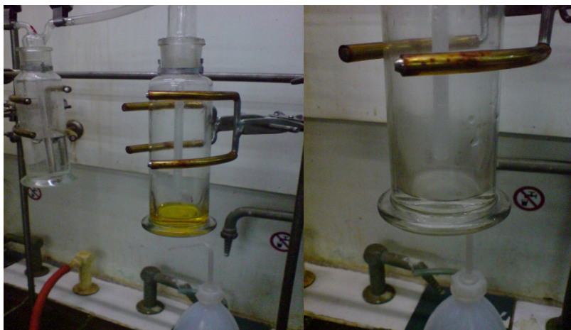
1. Beginnende Entfärbung durch Ethen 2. Vollständige Entfärbung
