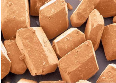
Abb. 3: Saccharose-Kristalle unter dem Elektronenmikroskop [2]
