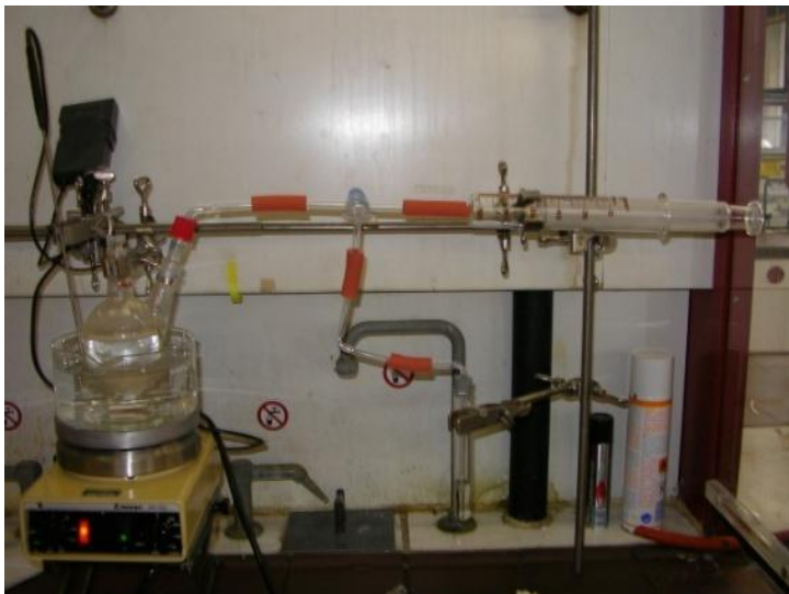
Abb. 2: Versuchsaufbau bei Verwendung der immobilisierten Hefe-Zellen.
