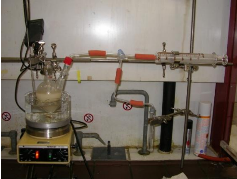
Abb. 4: Versuchsaufbau bei Verwendung der Hefe-Suspension.
