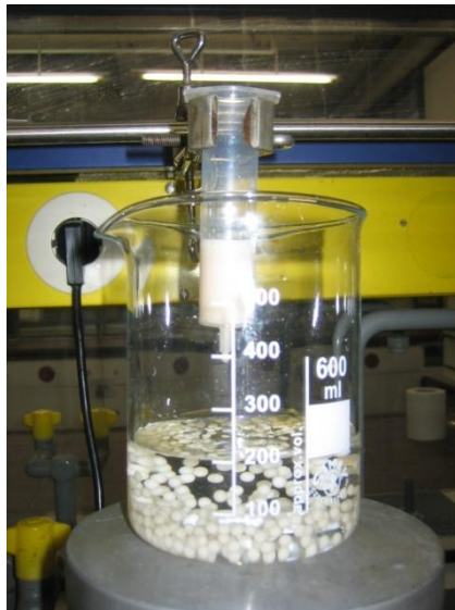
Abb. 1: Herstellung der Calciumalginat-Hefe-Kugeln.
