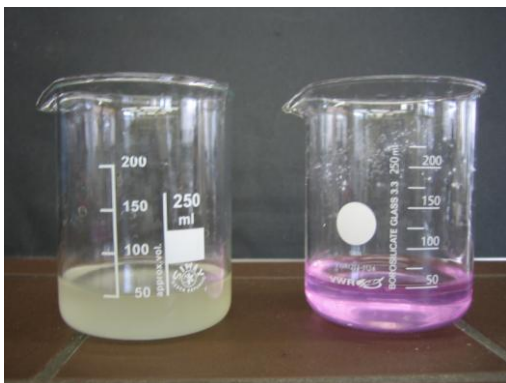
Abb. 1: links Petrolether mit Sebacinsäure, rechts Wasser mit Hexamethylen-diamin und Natriumcarbonat.
