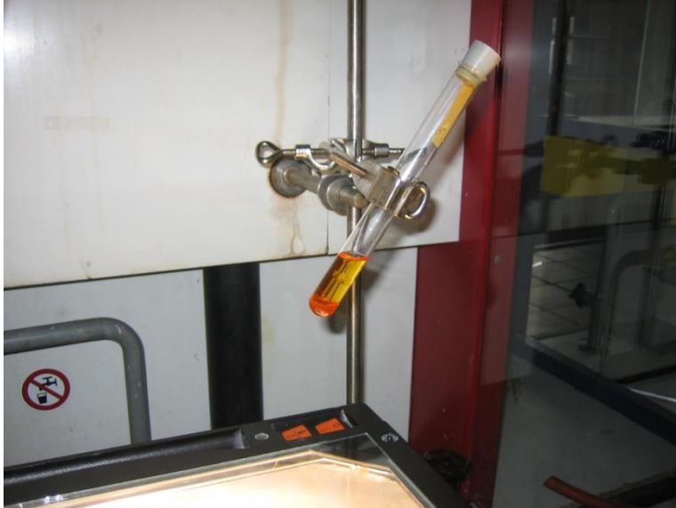
Abb. 4: Mischung von Toluol mit Bromwasser
