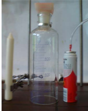
Abb. 1: Kerze, Gaszylinder, Dose mit Feuerzeuggas.
