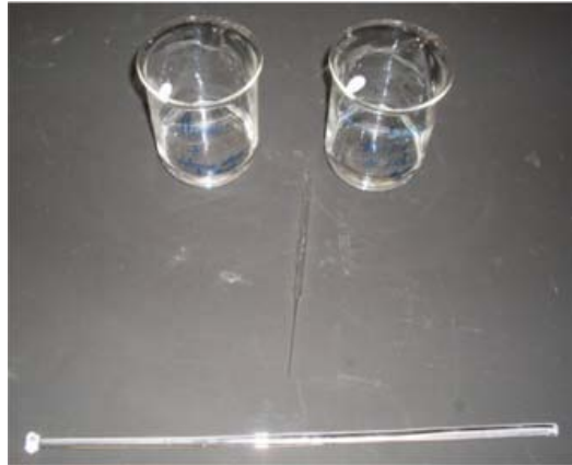
Abb. 1: Die beiden Lösungen vor der Überschichtung, sowie Glasstab und Tropfpipette zum Aufwickeln des Nylonfadens
