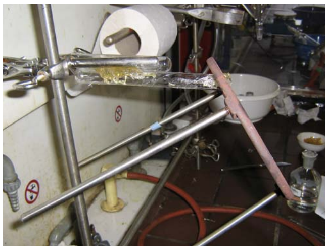
Demonstration der Stärke des Klebers ( 2 miteinander verklebte Reagenzgläser halten einen Dreifuß)
