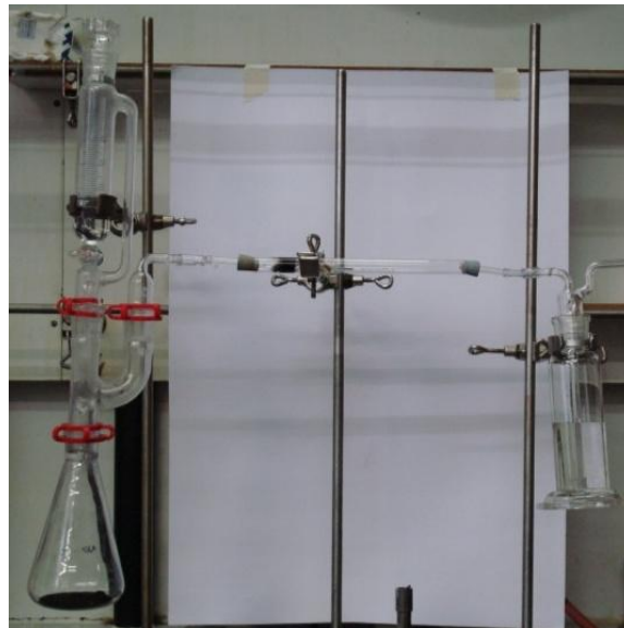
Abb. 9: Versuchsaufbau für die Synthese von Natriumchlorid aus den Elementen
