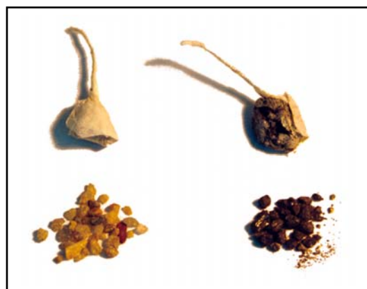
Abb. 14: Eine Knallerbse und deren Inhalt vor und nach der Zündung; es hat sich amorphes Silber abgeschieden.
